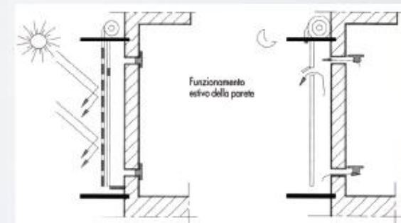
Il muro Trombe
